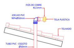
DET. DA EXTREMIDADE DA VENTILAÇÃO ESCALA RELATIVA
