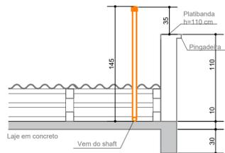
DETALHE SAÍDA TUBO DE VENTILAÇÃO S/ESC
