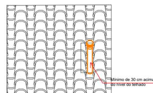
DETALHE SAÍDA TUBO DE VENTILAÇÃO NO TELHADO S/ESC
